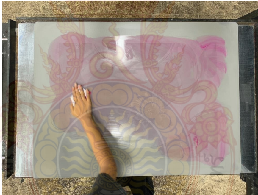
ภาพที่ 34 ขั้นตอนการลงน้ำยาเลทแลคเกอร์เปิดเฟลทแม่พิมพ์อลูมิเนียม ที่มา : ข้อมูลจากผู้เขียน
