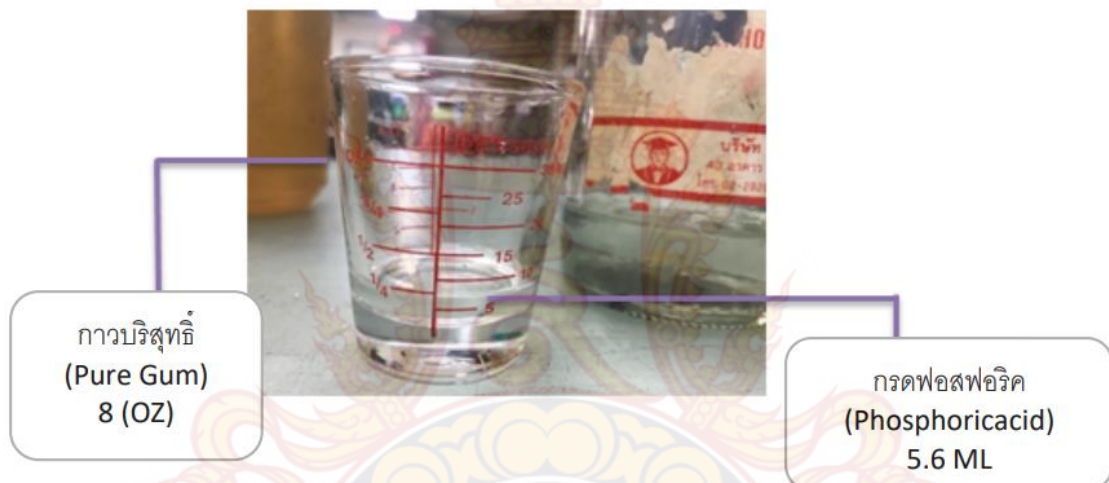
ภาพที่ 25 ขั้นตอนการเตรียมกาวกัดกรด
