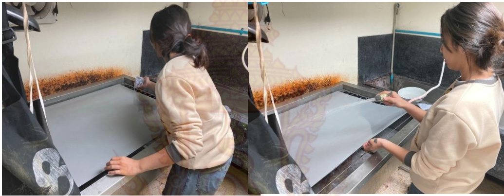
ภาพที่ 18 ขั้นตอนการล้างแผ่นอลูมิเนียม (Aluminum Plate)
