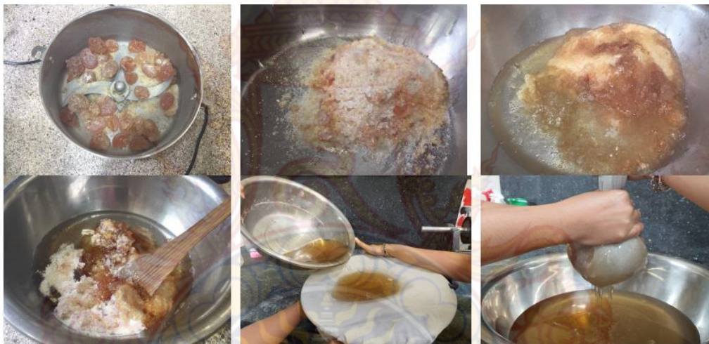
ภาพที่ 21 ขั้นตอนการเตรียมกาวกระถิน
