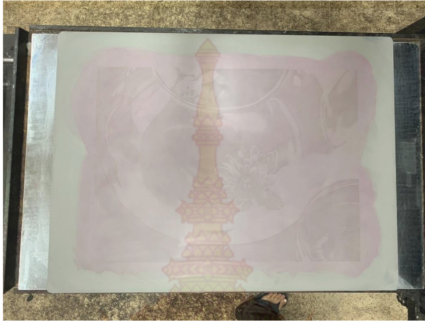
ภาพที่ 35 ขั้นตอนการชุบน้ำยาเลทแลคเกอร์บาง ที่มา : ข้อมูลจากผู้เขียน
