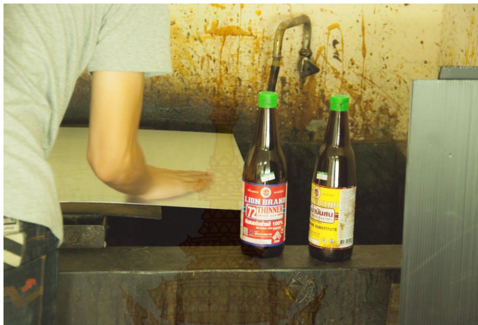
ภาพที่ 31 เตรียมเพลทตะกั่วผสมดีบุก โดยการนำเพลทมาล้าง น้ำมันสน ทินเนอร์และน้ำยาล้างจาน ที่มา : ข้อมูลจากผู้เขียน
