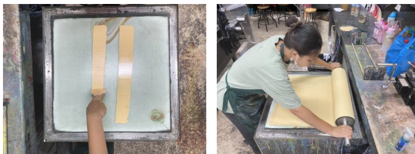
ภาพที่ 42 ขั้นตอนการเตรียมความพร้อมของหมึกพิมพ์ ที่มา : ข้อมูลจากผู้เขียน
