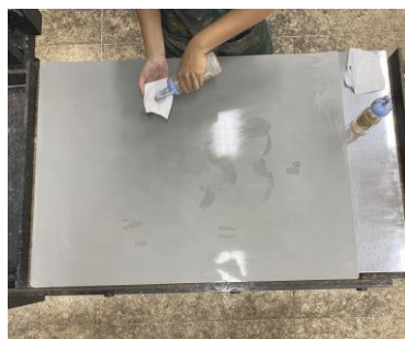
ขั้นตอนที่ 1 น้ำมันสนชุบผ้าเช็ดคาบไซด้าออก ขั้นตอนที่ 2 น้ำมันทินเนอร์ชุบผ้าเช็ดคาบไซท์ที่เหลือออกให้หมด
