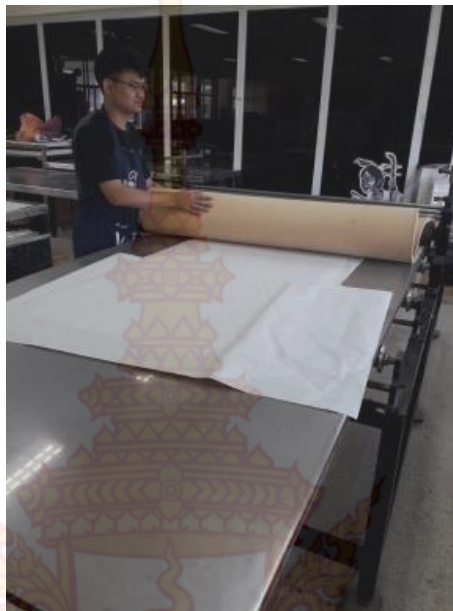
ภาพที่ 32 ขั้นตอนการสร้างทำแม่พิมพ์แกะไม้ การพิมพ์ตราฟแม่พิมพ์โดยการเข้าแท่น
