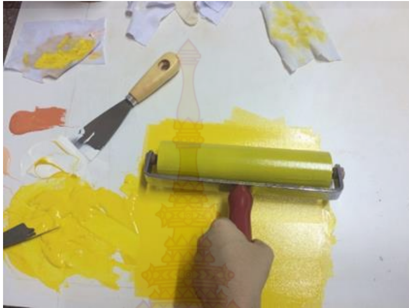
ภาพที่ 49 นำลูกกลิ้งไปกลิ้งหมึกบนแม่พิมพ์ ที่มา : ข้อมูลจากผู้เขียน
