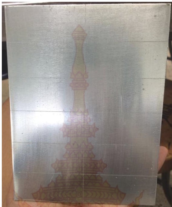
ภาพที่ 80 ภาพของแม่พิมพ์ก่อนที่จะนำเข้าสู่กระบวนการโรยผงเลือดมังกร ที่มา : ข้อมูลจากผู้เขียน
