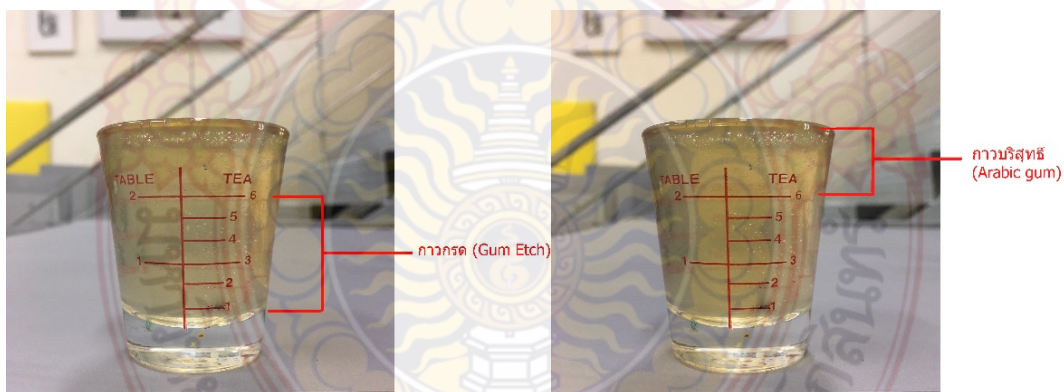
ภาพที่ 33 การผสมกาวกรดในการกัดกรด
