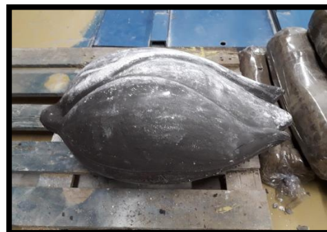
ภาพที่ 35 ตกแต่งชิ้นงาน รอดึงแห้งแล้วนำเข้าเตาเผาดิบ
