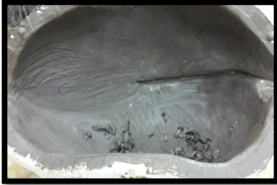
ภาพที่ 30 อุดเชื่อมรอยต่อดิน
