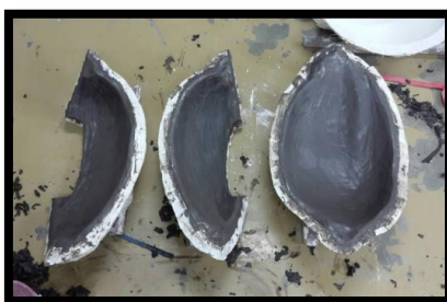
ภาพที่ 28 รอดินที่อัดพิมพ์เสร็จแข็ง
