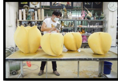
ภาพที่ 37 ตกแต่งสีเคลือบชุดโต๊ะเก้าอี้สนาม 06
