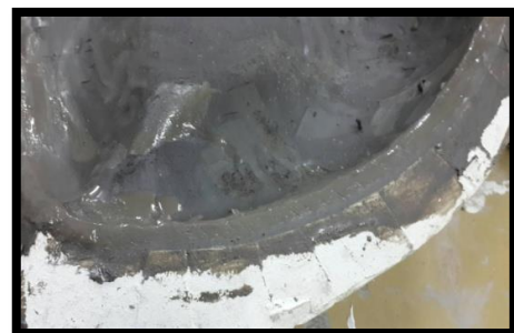
ภาพที่ 27 ควบคุมดินให้หนาประมาณ 1.5 ซม.
