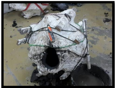
ภาพที่ 32 ประกอบพิมพ์แล้วรัดด้วยเชือก
