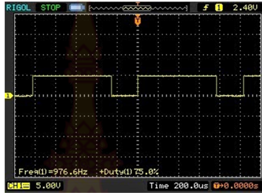
ภาพที่ ๒ - ๔๕ ตัวอย่างการทำ Duty Cycle ของ PWM (๗๕%)
