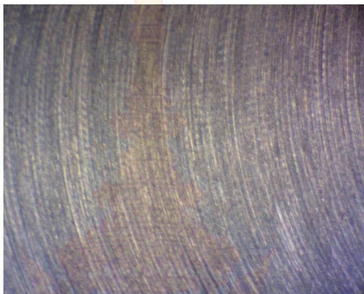
ภาพที่ ข.11 การทดลองที่ 4 / 2 ค่าความหยาบผิว Ra เป็น 1.56 \mu\text{m}
