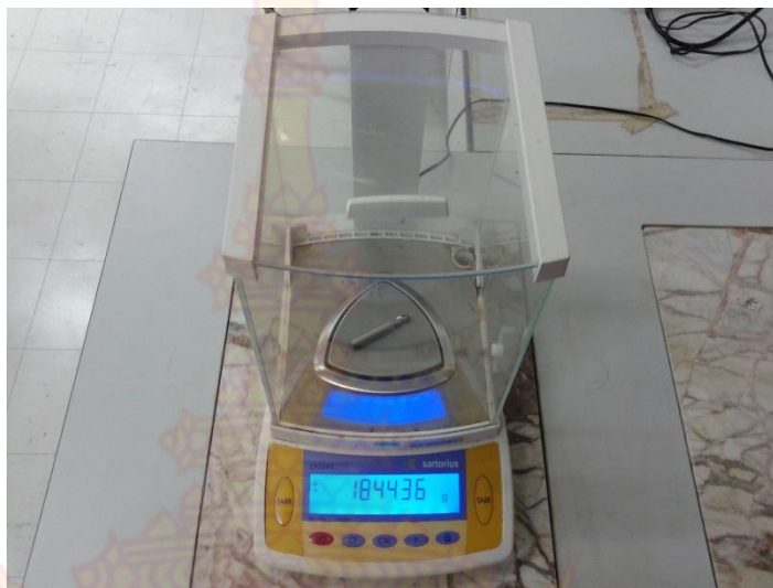
ภาพที่ 3.3 เครื่องชั่งน้ำหนักวัดขนาดความลึกหรือของคมตัด
