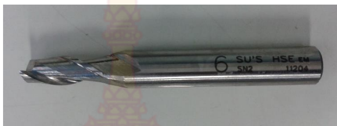
ภาพที่ 3.5 ดอกกัด (End Mill) HSS) แบบ 2 คมตัด
