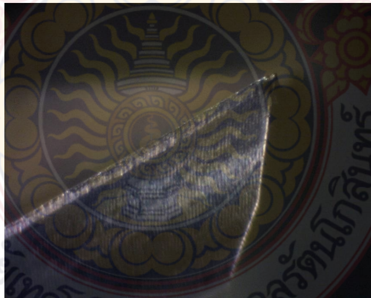
ภาพที่ ค.14 การทดลองที่ 5 / 1 สีกหรอ 0.0014 กรัม
