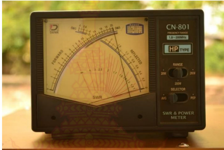
ภาพที่ 81 เครื่องมิเตอร์วัดกำลังงานและการสะท้อนกลับ ณ กำลังงานเครื่องส่งขนาด 20 วัตต์
