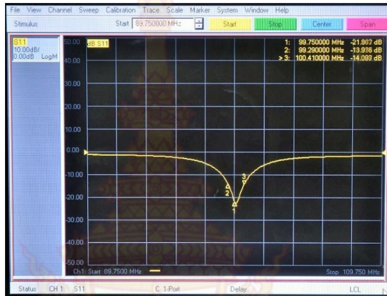
ภาพที่ 86 การวัดความกว้างของแบนด์วิดท์ของสายอากาศเซอร์คูลาร์ตัวที่ 1
