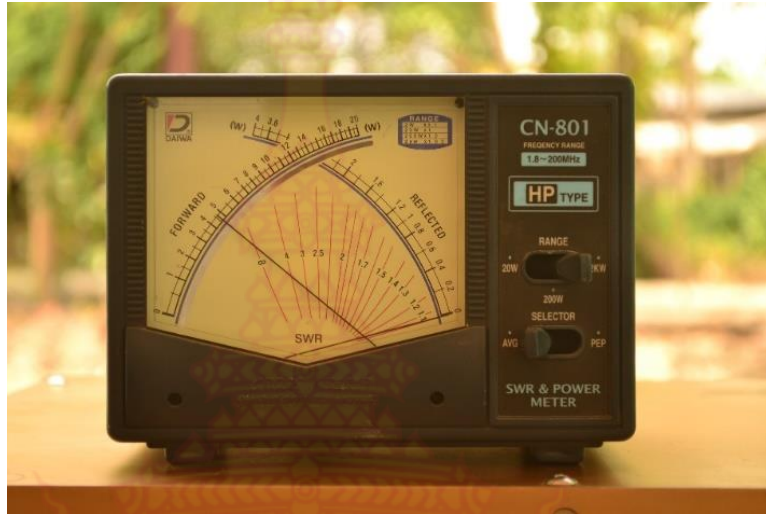
ภาพที่ 84 เครื่องมิเตอร์วัดกำลังงานและการสะท้อนกลับ ณ กำลังงานเครื่องส่งขนาด 460 วัตต์
