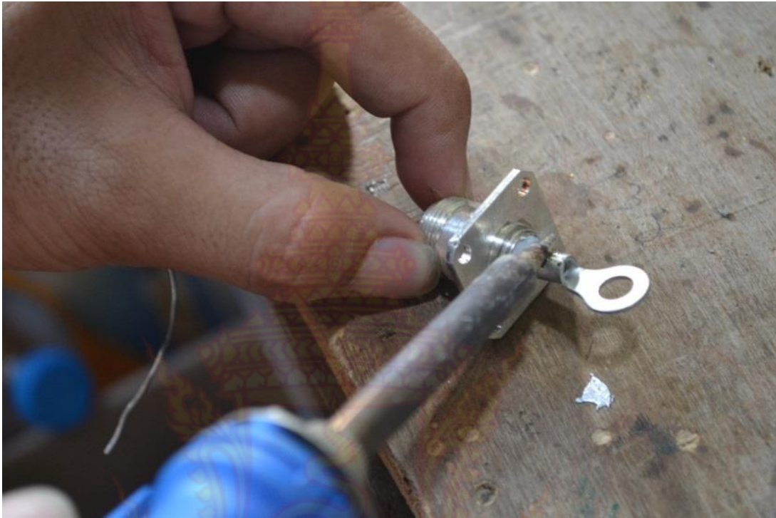
ภาพที่ 23 การบัดกรีหางปลาเข้ากับคอนเนคเตอร์ เพื่อใช้เป็นตัวยึดสตัป
