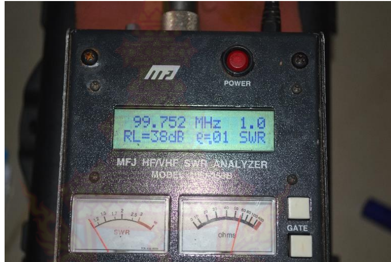
ภาพที่ 47 ผลการทดสอบของสายอากาศตัวที่ 2 ด้วยเครื่อง MFJ-259b
