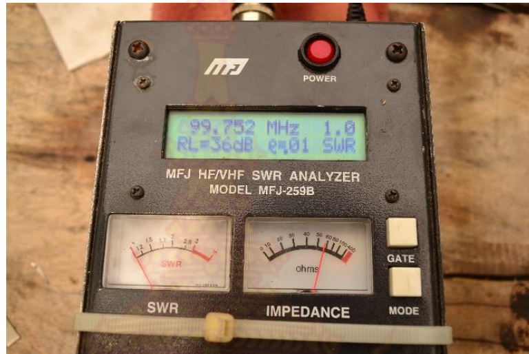
ภาพที่ 44 ผลการทดสอบของสายอากาศตัวที่ 1 กับสาย RG-8 ด้วยเครื่อง MFJ-259b
