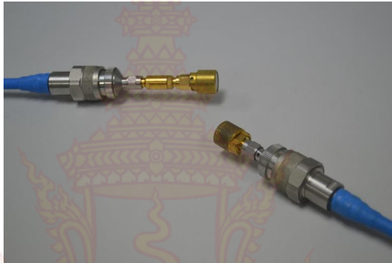
ภาพที่ 57 การต่อพอร์ต 1 (Port1) และพอร์ต 2 (Port2) เข้ากับหัวปรับเทียบแบบโพลด (BROADBAND LOAD)
