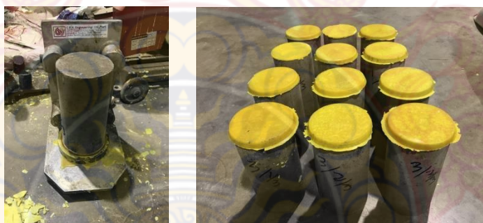
รูปที่ 3.24 แสดงการ Cap แท่งคอนกรีต
