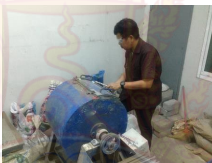
รูปที่ 3.21 แสดงการบดเก้าอี้ขานอ้อยละเอียดใช้เครื่อง Los Angeles Abrasion Machine
