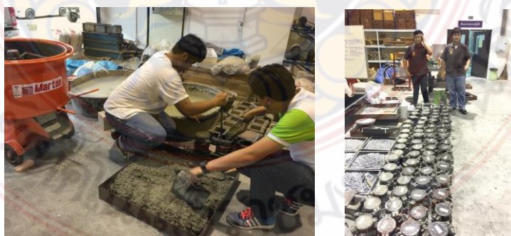
รูปที่ 3.22 แสดงการผสมคอนกรีตโดยวิธี ACI
