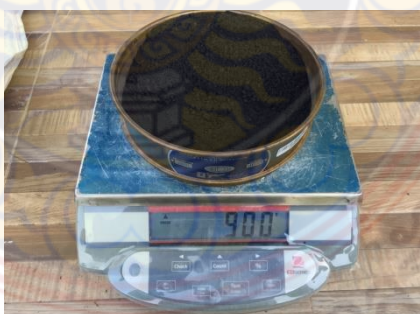
รูปที่ 3.19 แสดงการชั่งน้ำหนักถ้ำขานอ้อยที่ค้างบนตะแกรงเบอร์ 20
