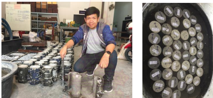
รูปที่ 3.23 แสดงการแกะแบบหล่อคอนกรีต และทำการบ่มแห้งคอนกรีต
