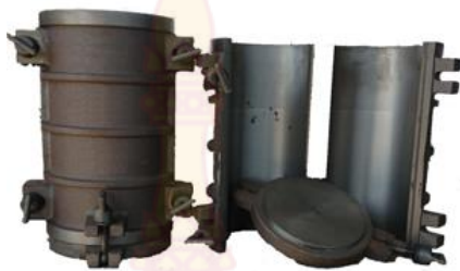
รูปที่ 3.13 แสดงแบบหล่อคอนกรีต ชนิด CYLINDER MOLD ( ขนาด \varnothing 10 ซม. สูง 20 ซม. )
