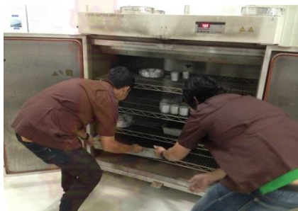
รูปที่ 3.20 แสดงการนำเก้าอี้ขานอ้อยอบที่อุณหภูมิ 100 องศาเซลเซียส
