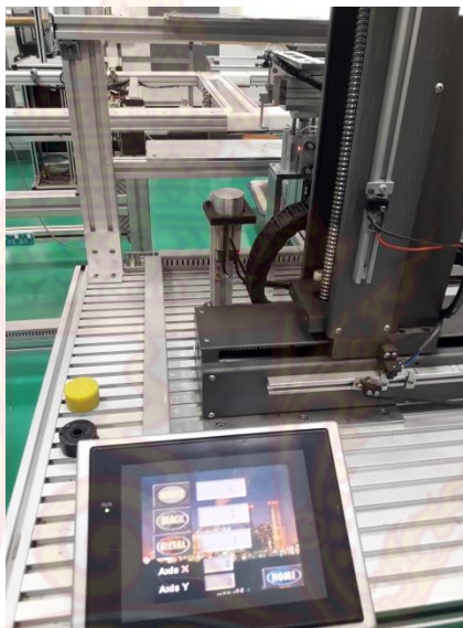
ภาพที่ 4-1 การตรวจสอบ METAL ที่จุดตรวจ และการแสดงผลที่หน้าจอทัชสกรีน
