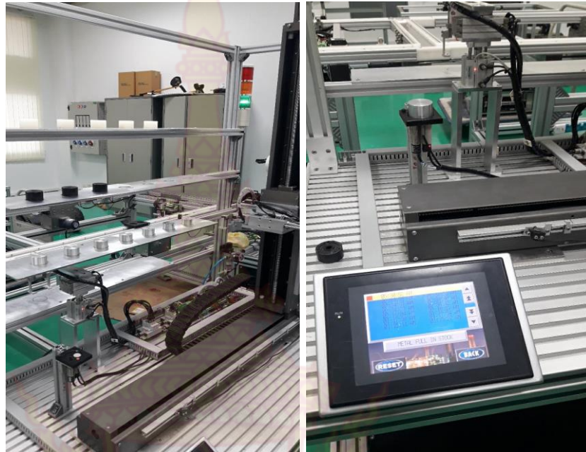
ภาพที่ 4-2 สัญญาณไฟเมื่อวัตถุ METAL เต็ม และการแจ้งเตือน ALARM ที่จอทัชสกรีน
