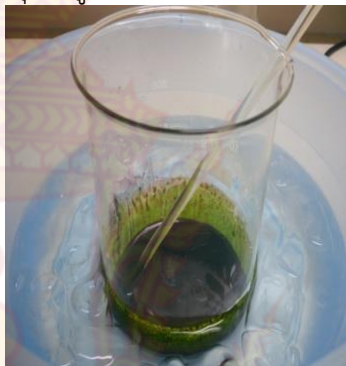
รูปที่ 3.1 แสดงการผสมระหว่างกรดซัลฟิวริกเข้มข้นกับโซเดียมไนเตรท ผงแกรไฟต์และผงโพแทสเซียมเปอร์แมงกาเนส (ใน ice bath)
