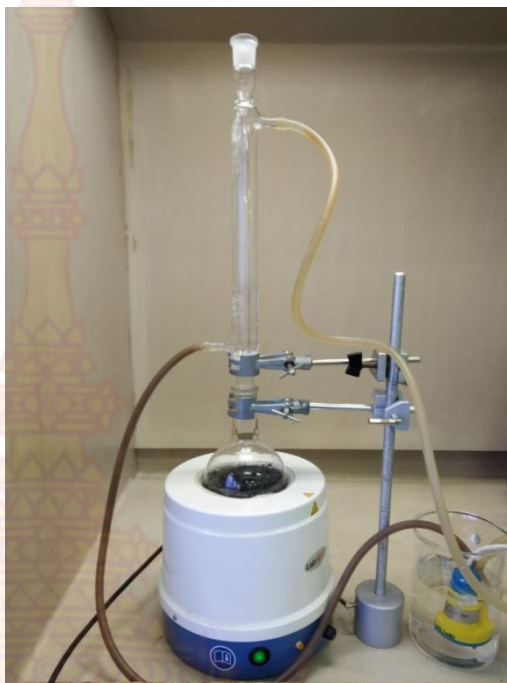
รูปที่ 3.3 แสดงการเตรียมรีดิวซ์แกรฟีนออกไซด์ด้วยวิธีการรีฟลักซ์ เป็นเวลา 12 ชั่วโมง
