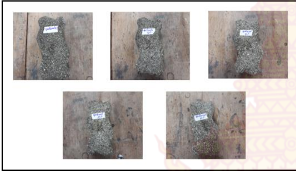
ภาพที่ 1 ลักษณะตัวอย่างทดสอบบล็อกรูปร่างที่ผลิตจากวัสดุชั้นทางเดิมเสื่อมคุณภาพผสมปูนซีเมนต์ปอร์ตแลนด์ประเภท 1 ที่ปริมาณปูนซีเมนต์ร้อยละ 1-5
