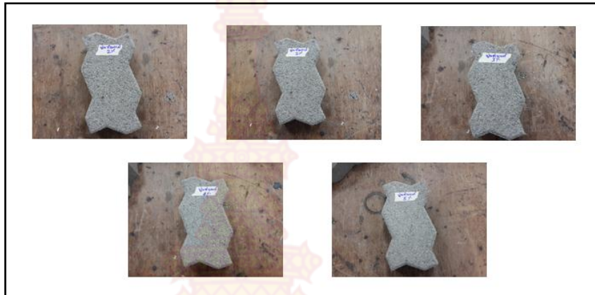
ภาพที่ 4-2 ลักษณะตัวอย่างทดสอบบล็อกปูพื้นจากวัสดุชั้นทางเดิมเสื่อมคุณภาพผสมหินฝุ่น ที่อัตราส่วน 1: 1 ผสมปูนซีเมนต์ปอร์ตแลนด์ประเภท 1 ที่ปริมาณปูนซีเมนต์ร้อยละ 1-5
