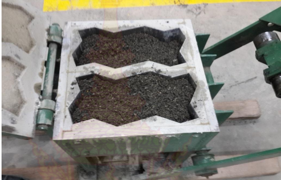
ภาพที่ ค-7 เทวัสดุผสมที่ผ่านการชั่งตวงแล้ว ใส่ในช่องอัดขึ้นรูปบล็อกปูพื้น
