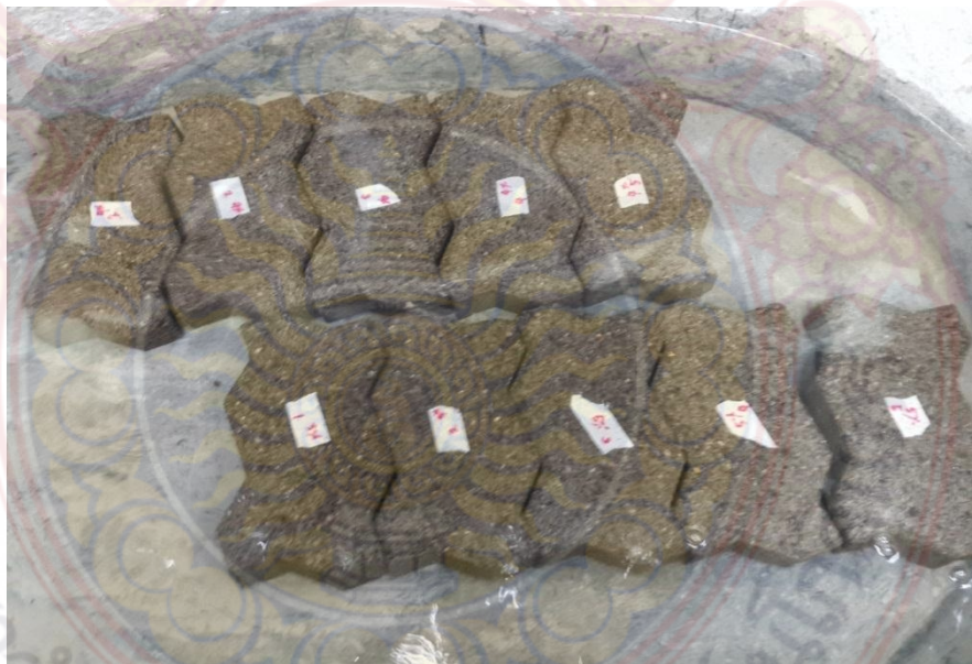
ภาพที่ ค-11 การตรวจสอบลักษณะทั่วไปและมิติของตัวอย่างทดสอบบล็อกปูพื้น ที่อายุการบ่ม 28 วัน
