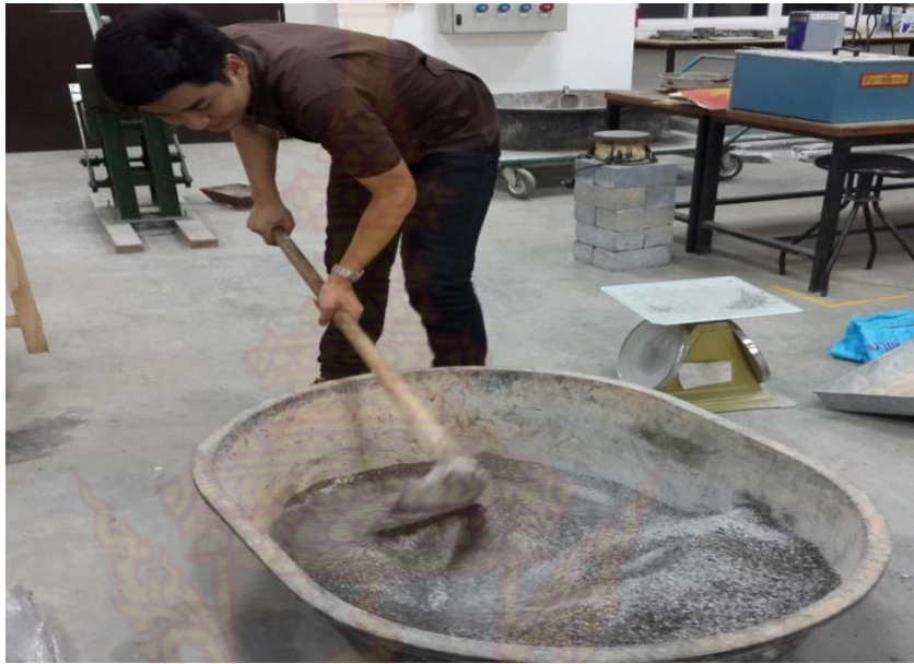
ภาพที่ ค-5 การผสมวัสดุให้เข้ากัน หลังจากการผสมด้วยเครื่องผสม
