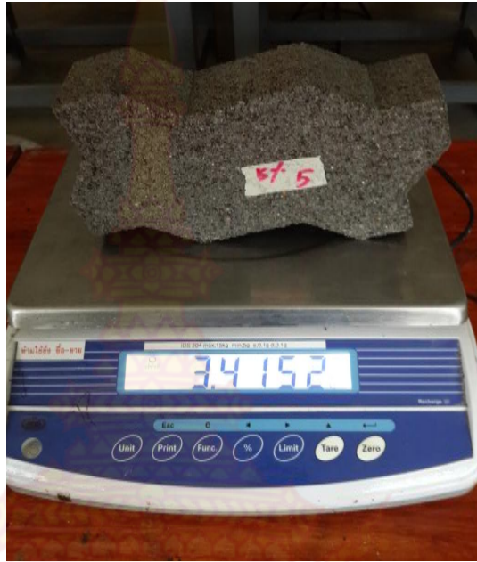
ภาพที่ ค-13 ทำการชั่งน้ำหนักตัวอย่างทดสอบเพื่อหาค่าการดูดกลืนน้ำ และความหนาแน่นแห้งของบล็อกปูพื้นที่อายุการบ่ม 28 วัน
