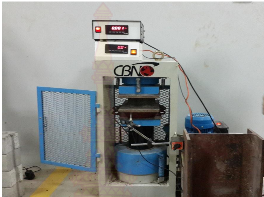
ภาพที่ ค-15 ทำการทดสอบหาค่าความต้านทานแรงอัดของตัวอย่างทดสอบบล็อกปูพื้น ที่อายุการ บ่ม 7, 14, 28 วัน
