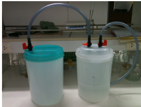
รูปที่ 1 ลักษณะการต่อชุดถังหมัก
