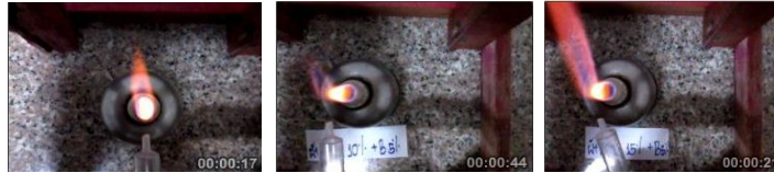
รูปที่ 8 การติดไฟของก๊าซชีวภาพที่เกิดขึ้นเมื่อหมักของเสียจากบ่อเกรอะ: ผักตบชวา + Bacillus sp.
