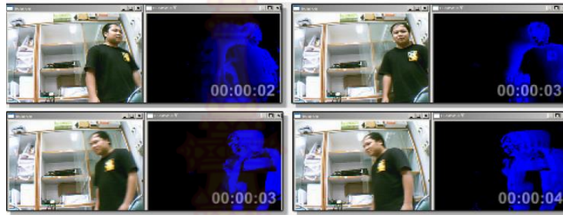
ภาพที่ 2-7 การวิเคราะห์การเคลื่อนไหวด้วยการลบพื้นหลังแบบเฟรมติดกัน (ที่มา: การศึกษาเบื้องต้นการนำเทคโนโลยีทางด้านการประมวลผลภาพมาใช้ในระบบรักษาความปลอดภัย, ดร.นิคม สุวรรณวร, 2550)
