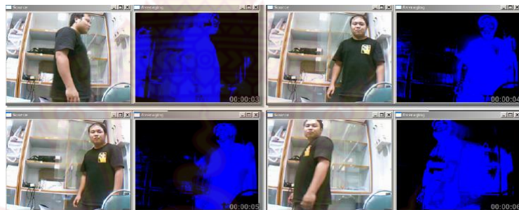
ภาพที่ 2-8 การวิเคราะห์การเคลื่อนไหวด้วยการลบพื้นหลังแบบเลือกพื้นที่ (ที่มา: การศึกษาเบื้องต้นการนำเทคโนโลยีทางด้านการประมวลผลภาพมาใช้ในระบบรักษาความปลอดภัย, ดร.นิคม สุวรรณวร, 2550)
