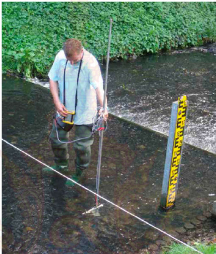
รูปที่ 3-5 การใช้งานมิเตอร์วัดกระแสในลำธารขนาดเล็ก [4]
