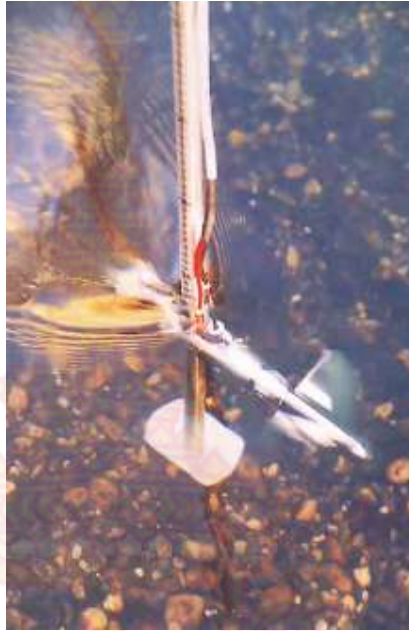
รูปที่ 3-2 การใช้มิเตอร์ A-OTT วัดกระแสหน้า [4]
