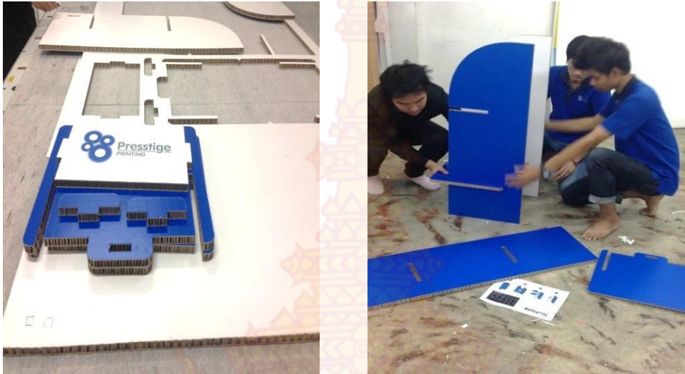
ภาพที่ 2.18 รูปแบบชิ้นส่วนเฟอร์นิเจอร์จากกระดาษรีงผึ้ง เพื่อประกอบเป็นเฟอร์นิเจอร์ ที่มา: (ปรีฉัตร เสนาะคำ)
