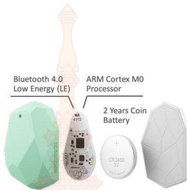
รูปที่ 2.4 แสดงส่วนประกอบหลักของ Beacon
