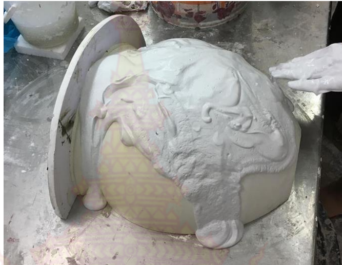
ภาพที่ ๑๑ การเทปูนพลาสติกเพื่อทำพิมพ์ชิ้นแรก
