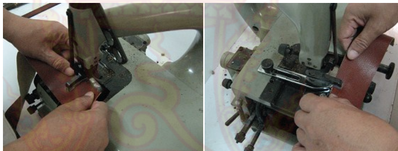
ภาพที่ 4.38 การเจียนหนังหรือการลอกหนัง ชิ้นส่วนต่างๆ ของกระเป๋าแบบที่ 3 ที่มา : ธวัชชัย เทียนประทีป
