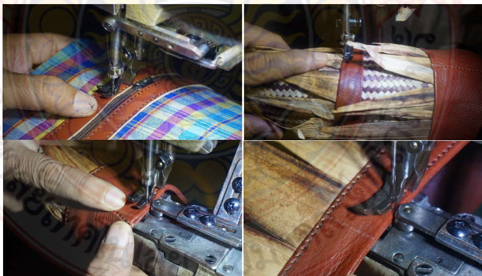
ภาพที่ 4.17 การเย็บชิ้นส่วน การประกอบรูปทรง กระเป๋าแบบที่ 1 ที่มา: ธวัชชัย เทียนประทีป
