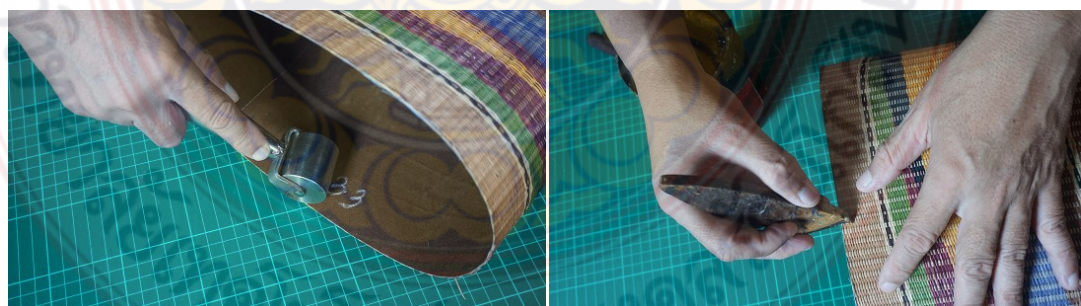
ภาพที่ 4.62 การเขียนหนังหรือการลอกหนัง ชิ้นส่วนต่างๆ ของกระเป๋าแบบที่ 4 ที่มา: ธวัชชัย เทียนประทีป
