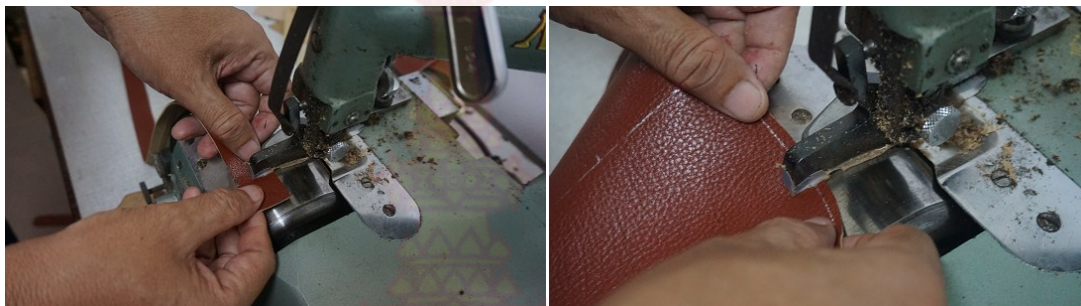
ภาพที่ 4.50 การเจียนหนังหรือการปกหนัง ชิ้นส่วนต่างๆ ของกระเป๋าแบบที่ 4 ที่มา : ธวัชชัย เทียนประทีป
