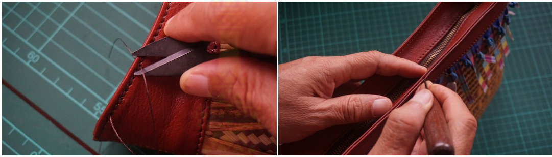
ภาพที่ 4.18 การตกแต่งกระเป๋า การตัดด้าย การเข็ดกาว กระเป๋าแบบที่ 1 ที่มา: ธวัชชัย เทียนประทีป
