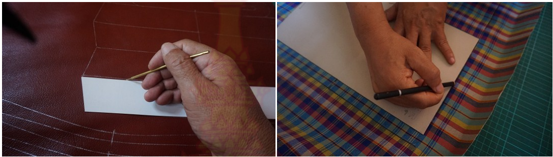
ภาพที่ 4.25 การวาดหนัง และการวาดซ้ำใน การตัดซ้ำใน กระเป๋าแบบที่ 2 ที่มา : ธวัชชัย เทียนประทีป
