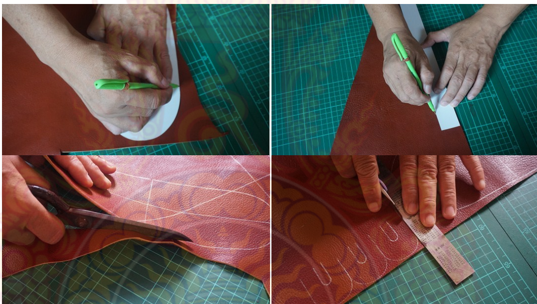
ภาพที่ 4.48 การวาดหนัง การตัดหนังด้วยกรรไกร - คัทเตอร์ กระเป๋าแบบที่ 4 ที่มา : ธวัชชัย เทียนประทีป
