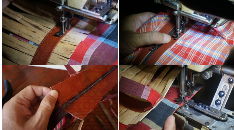
ภาพที่ 4.40 การเย็บชิ้นส่วนต่างๆของกระเป๋า และการเย็บประกอบรูปทรง ของกระเป๋าแบบที่ 3 ที่มา: ธวัชชัย เทียนประทีป
