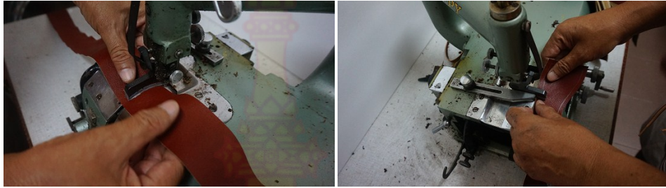
ภาพที่ 4.15 การเย็บหนังหรือการปกหนัง ชิ้นส่วนต่างๆ กระเป๋าแบบที่ 1 ที่มา: ธวัชชัย เทียนประทีป
