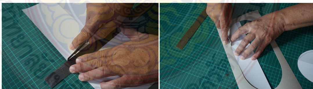
ภาพที่ 4.59 การตัดแพทเทิร์นกระเป๋า ด้วยกระดาษเทาขาว กระเป๋าแบบที่ 5 ที่มา : ธวัชชัย เทียนประทีป
