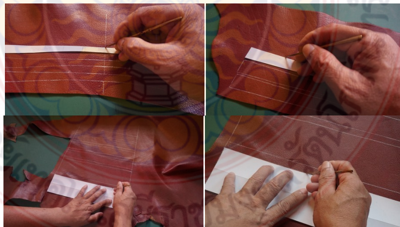
ภาพที่ 4.36 การวาดหนัง การตัดหนังด้วยคัทเตอร์ - กรรไกร กระเป๋าแบบที่ 3 ที่มา : ธวัชชัย เทียนประทีป
