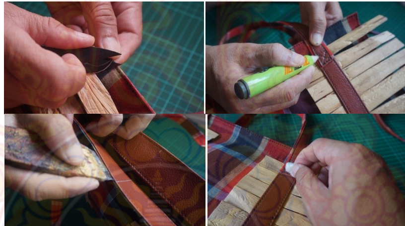
ภาพที่ 4.41 การตกแต่งกระเป๋ากการตัดด้ายการเช็ดรอยปากกาวาดหนัง การเช็ดรอยกาวกระเป๋าแบบที่ 3 ที่มา : ธวัชชัย เทียนประทีป
