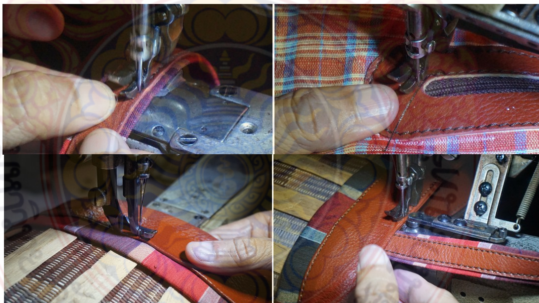
ภาพที่ 4.64 การเย็บชิ้นส่วนต่างๆของกระเป่า และการเย็บประกอบรูปทรงของกระเป่าแบบที่ 5 ที่มา : ธวัชชัย เทียนประทีป
