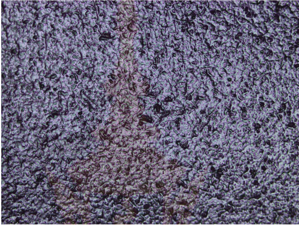
ตัวอย่างพื้นผิวที่เคลือบสีด้วย BOSANY Hi-Temp Spray paint (Black) 1039
