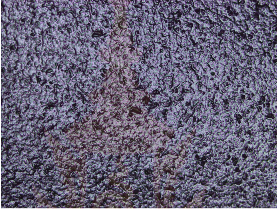
รูปภาพ 10 ตัวอย่างพื้นผิวที่เคลือบสีด้วย BOSANY Hi-Temp Spray paint (Black) 1039
