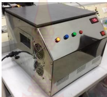
ภาพที่ 25 กระทะเทอร์โมอิเล็กทริกที่ประกอบเสร็จสมบูรณ์แล้ว
