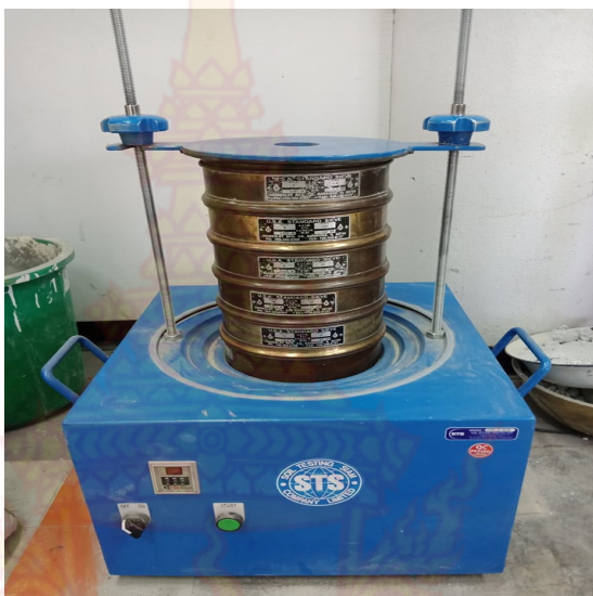
ภาพที่ 37 การนำตัวอย่างแก้วกันเตาที่เตรียมไว้เทใส่ลงบนตะแกรง
