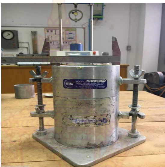
ภาพที่ 38 การวัดขนาดเส้นผ่าศูนย์กลางและความสูงของโมล
