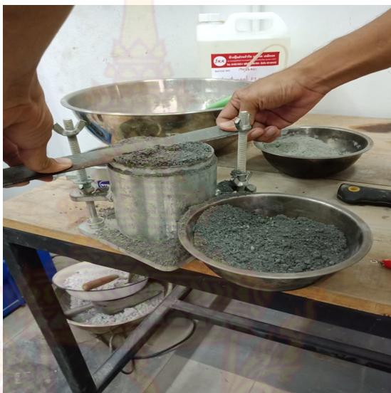
ภาพที่ 41 การปาดเถ้ากันเตา
