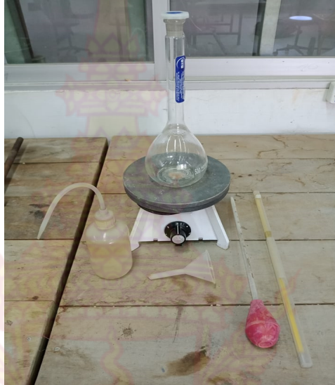
ภาพที่ 6 ชุดทดสอบหาความถ่วงจำเพาะของวัสดุ
