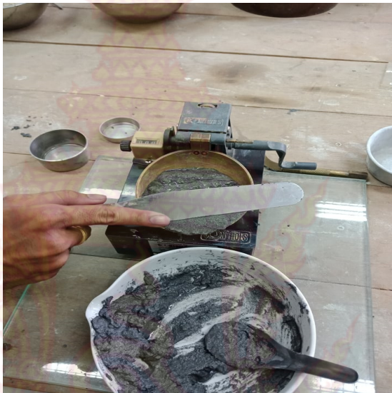
ภาพที่ 27 การใส่ตัวอย่างในถ้วยทองเหลือง
