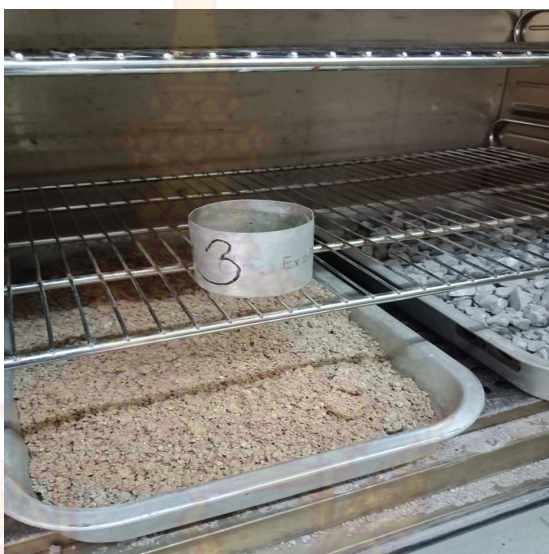
ภาพที่ 31 การนำตัวอย่างเถ้าก้นเตาเข้าสู่ตู้อบ
