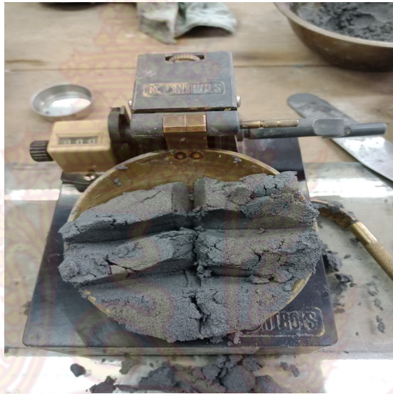
ภาพที่ 30 การบากเอ้ากันเตาเพื่อเก็บตัวอย่าง
