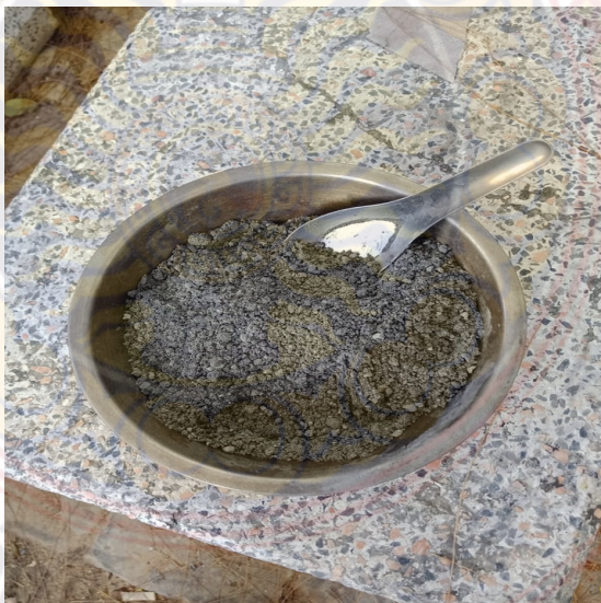
ภาพที่ 46 การผสมตัวอย่างกับน้ำให้เข้ากัน
