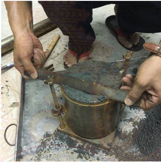
ภาพที่ 58 การปาดตัวอย่างทดสอบให้เรียบเสมอขอบโมล ซี.พี.อาร์.
