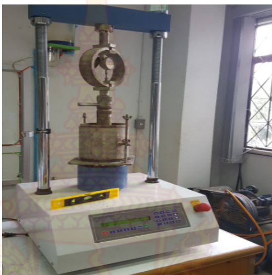
ภาพที่ 61 การปรับเข็มของวงแหวนวัดแรง
