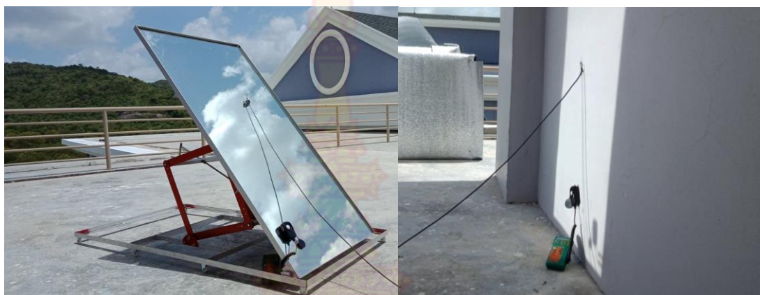
ภาพที่ 4.1 ทดลองโดยการสะท้อนแสงไปที่ผนังเพื่อเปรียบเทียบอุณหภูมิ ความเข้มแสง ระหว่างการสะท้อนแสง และการรับแสงโดยตรงจากดวงอาทิตย์
