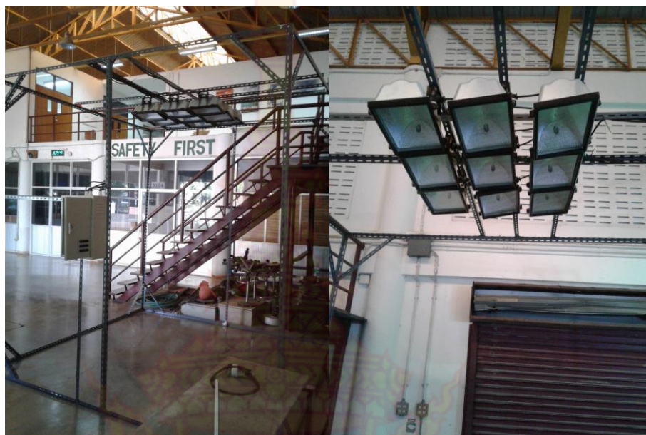
ภาพที่ 3.1 โครงสร้างระบบจำลองความเข้มแสง
