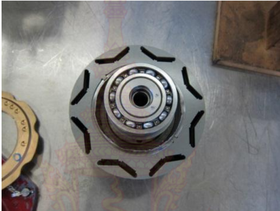
ภาพที่ 3 โรเตอร์ของมอเตอร์ซิงโครนัสชนิดแม่เหล็กถาวรในรถยนต์ Toyota Prius 2006
