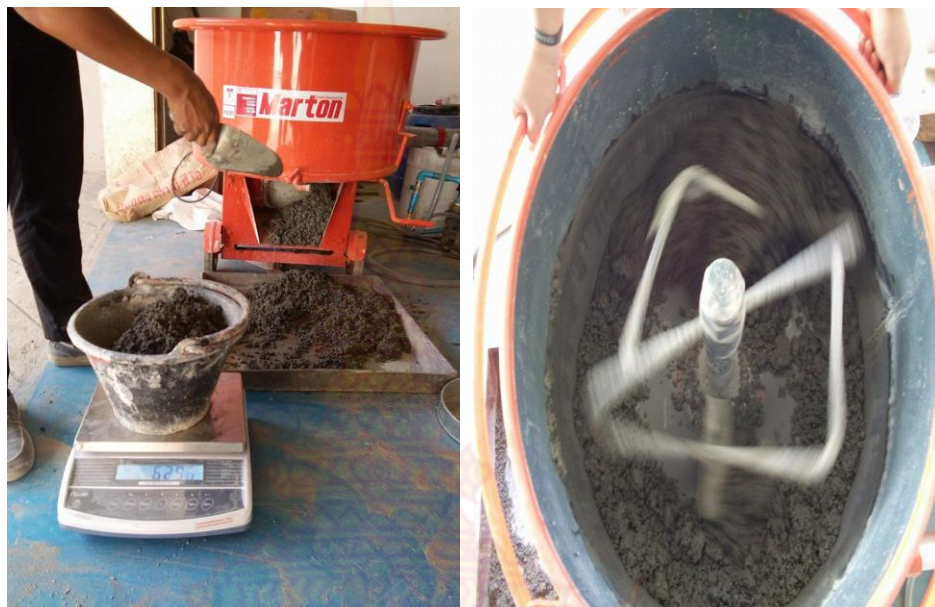
ภาพที่ จ-3 ทำการผสมให้เข้ากันแล้วนำเทลงใส่ถาด เพื่อทำการชั่งตวงวัสดุผสมในอันดับต่อไป
