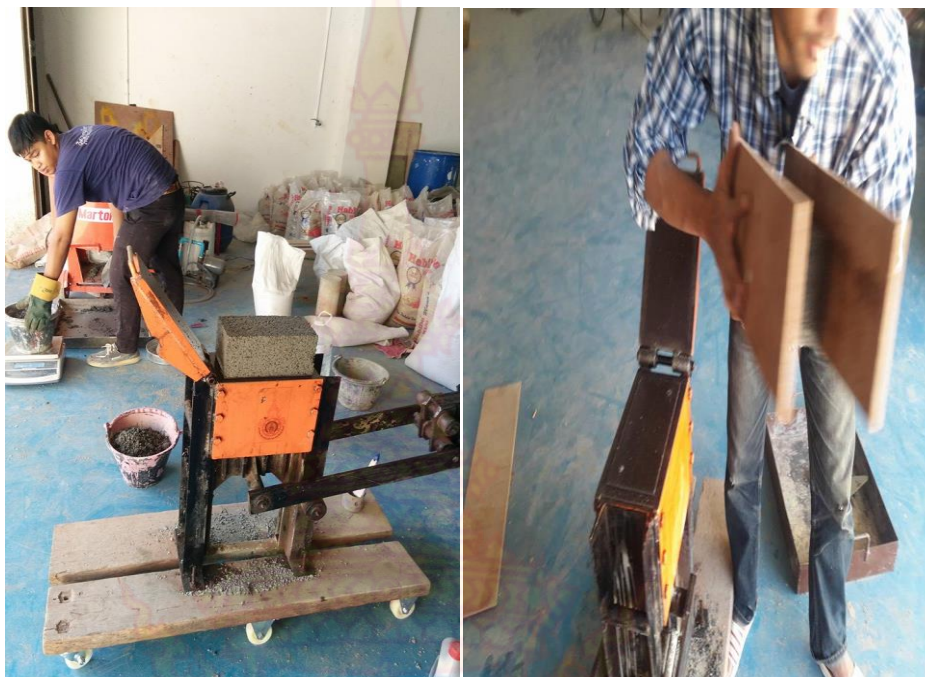
ภาพที่ จ-5 ทำการขนย้ายตัวอย่างทดสอบเมื่ออัดขึ้นรูปเป็นบล็อกประสานผสมน้ำยางพาราเสริมกำลังด้วยเส้นใยทะเลสายปาล์มและเศษยางรถยนต์
