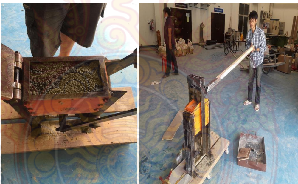
ภาพที่ จ-4 เทวัสดุผสมที่ผ่านการชั่งตวงแล้ว ใส่ในช่องอัดขึ้นรูป บล็อกประสานผสมน้ำยาพาราเสริม กำลังด้วยเส้นใยทะเลลายปาล์มและเศษยางรถยนต์เพื่อทำการอัดขึ้นรูป
