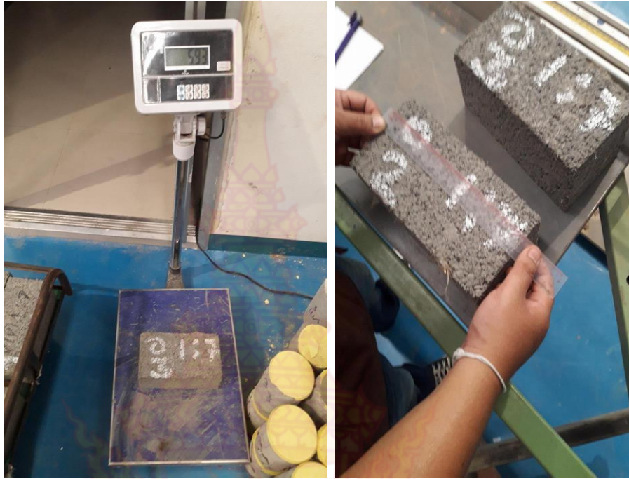
ภาพที่ จ-9 นำตัวอย่างทดสอบซึ่งน้ำหนักก่อนแช่น้ำเพื่อหาค่าการดูดซึมน้ำของบล็อกประสานผสมน้ำยางพาราเสริมกำลังด้วยเส้นใยทะเลลายปาล์มและเศษยางรถยนต์
