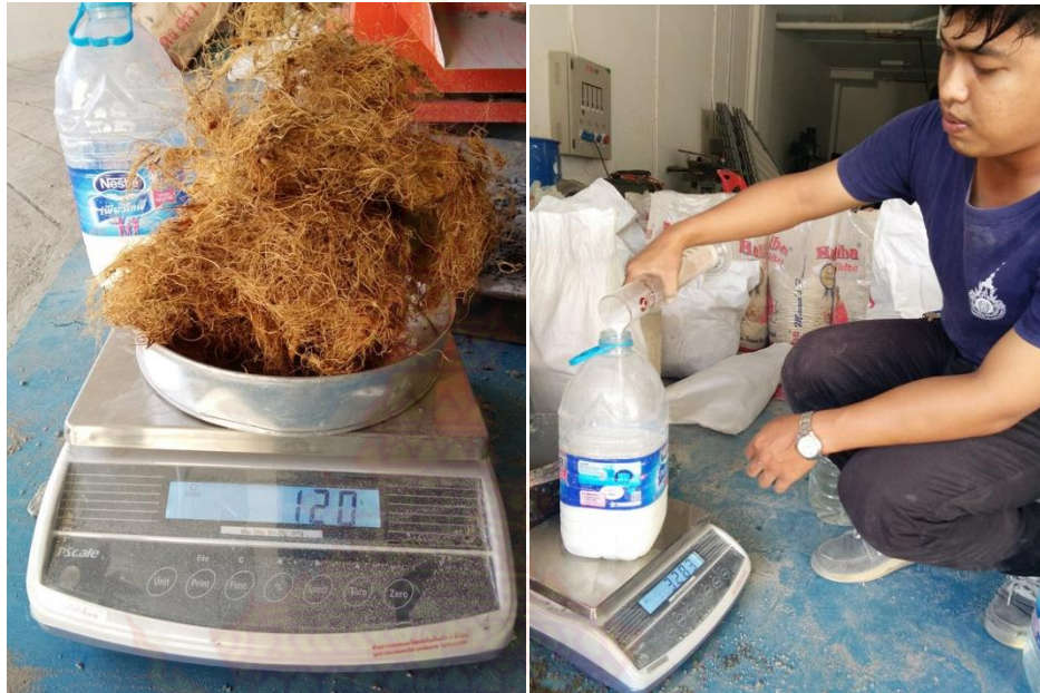
ภาพที่ จ-1 ชั่งน้ำหนักหินฝุ่นและวัดปริมาณของน้ำยางพาราตามอัตราส่วนผสม ไว้สำหรับผลิตบล็อก ประสานผสมน้ำยางพาราเสริมกำลังด้วยเส้นใยทะเลลายปาล์มและยางรถยนต์บด
