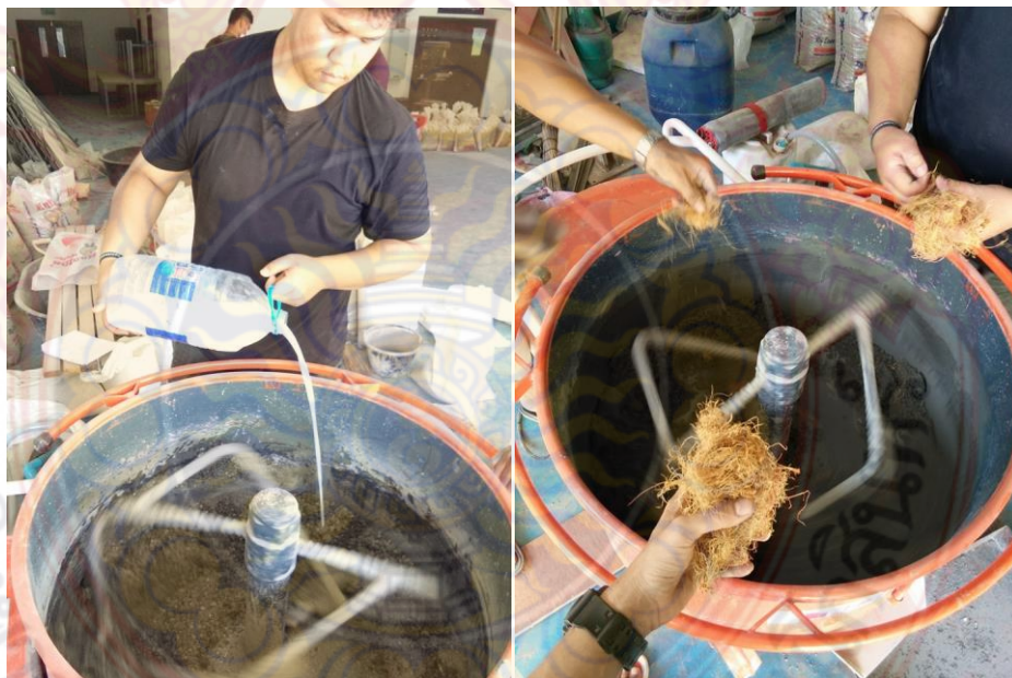
ภาพที่ จ-2 การผสมวัสดุในการทำตัวอย่างทดสอบบล็อกประสานผสมน้ำยางพาราเสริมกำลัง ด้วยเส้นใยทะเลลายปาล์มแลเศษยางรถยนต์ ทำการผสมโดยเครื่องผสมปูน
