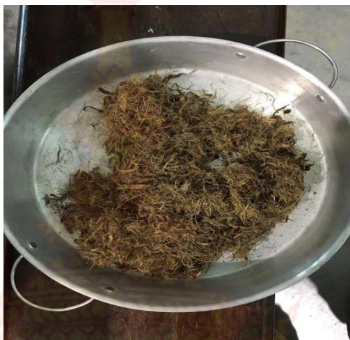
ภาพที่ 3-3 ลักษณะของเส้นใยทะเลลายเปล้าปาล์มสำหรับใช้ทำตัวอย่างทดสอบ
