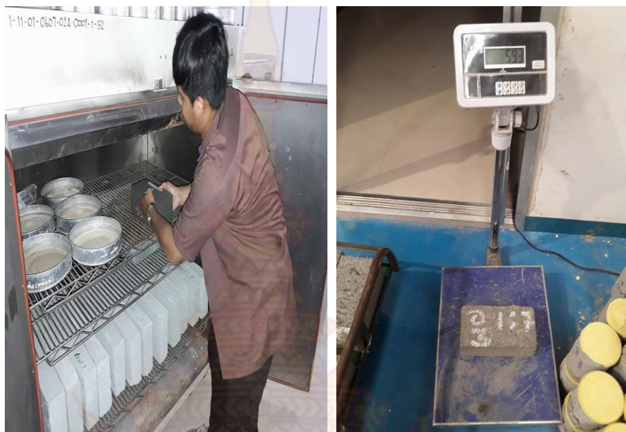
ภาพที่ จ-10 นำตัวอย่างทดสอบหลังแช่น้ำแล้วไปชั่งแล้วนำไปเข้าตู้อบ24ชั่วโมงจากนั้นนำมาชั่งเพื่อ คำนวณเพื่อหาค่าการดูดซึมน้ำบดล็อกประสานผลสมน้ำยางพาราเสริมกำลังด้วยเส้นใย ทะเลลายปาล์มและเศษยางรถยนต์
