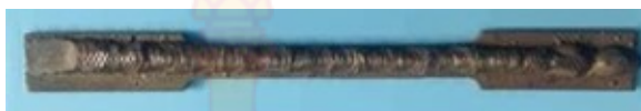
ภาพที่ 37 ตัวอย่างชิ้นงานทดสอบความต้านทานแรงดึง
