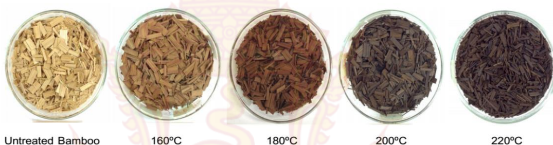
ภาพที่ 2-3 ลักษณะปรากฏของเส้นใยไผ่หลังจากผ่านกระบวนการ Hydrothermal treatment [15]
