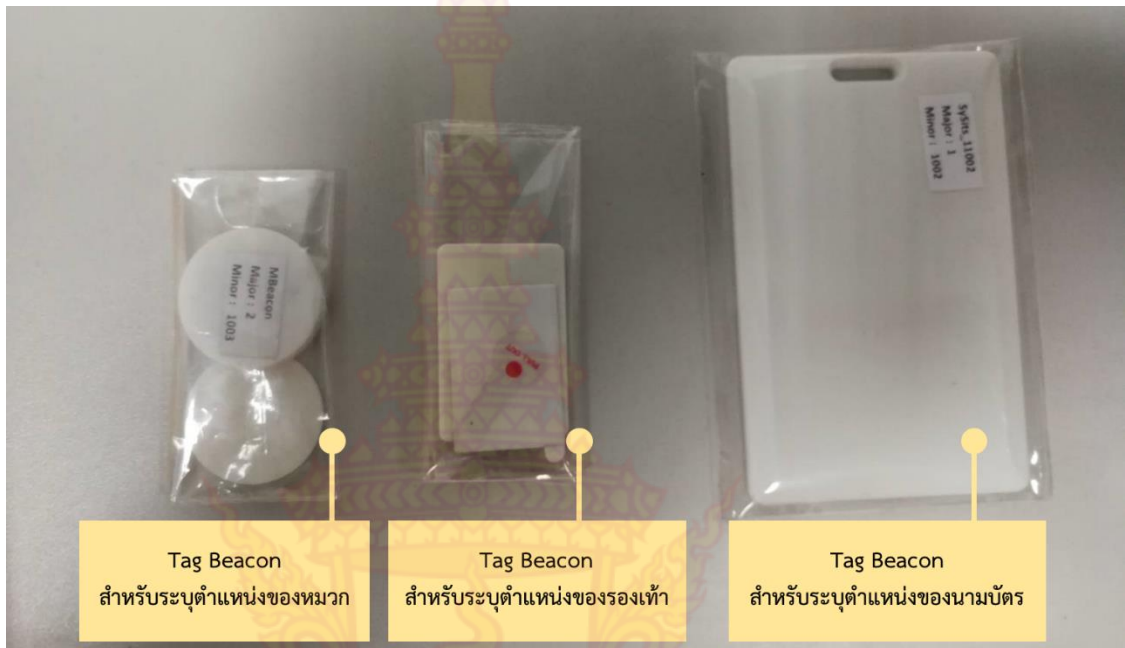
รูปภาพที่ 11 Tag Beacon ที่ใช้สำหรับติดตั้งอุปกรณ์ป้องกันส่วนบุคคล
