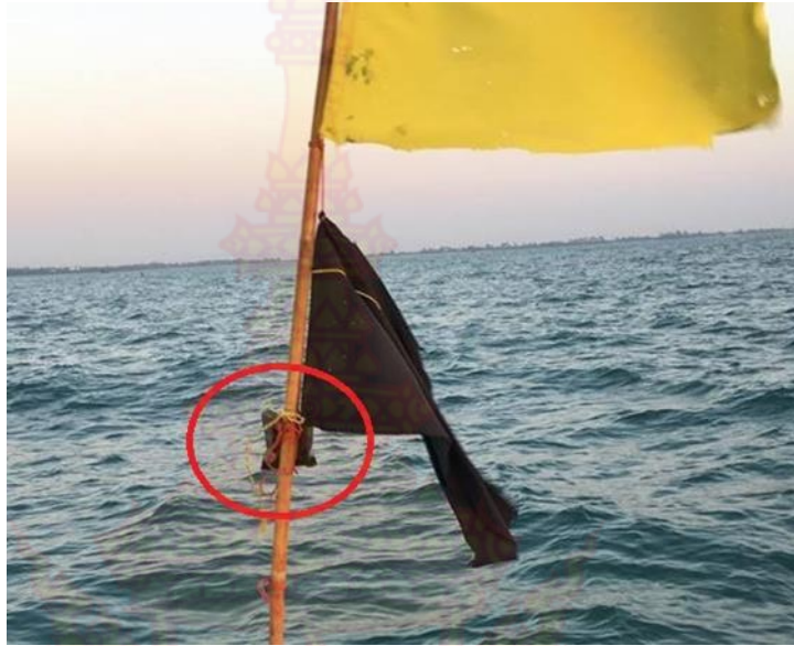
ภาพที่ 74 แสดง GPS เมื่อนำไปติดที่ทุ่น
