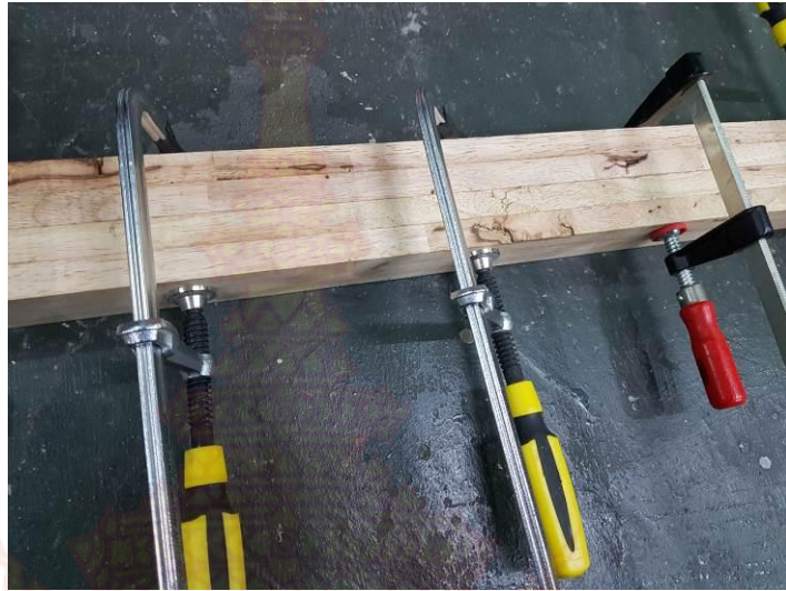
ภาพที่ 3-9 การหนีบไม้ด้วยแคลมป์เอฟหลังจากทากาวลงเท็ก ที่มา: สุชา ศิลปชัยศรี
