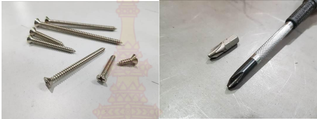
ภาพที่ 3-21 ลักษณะของตะปูเกลียวหลากหลายขนาด และหัวไขควงแฉกแบบมาตรฐาน PH2 ที่มา: สุชา ศิลปชัยศรี
