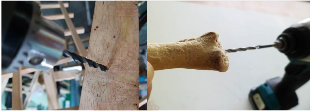
ภาพที่ 3-17 การเจาะวัสดุด้วยสว่านไฟฟ้า
