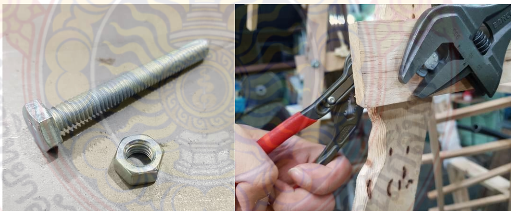
ภาพที่ 3-22 ลักษณะของน็อตตัวผู้, ตัวเมีย และการขันน็อตด้วยประแจเลื่อนกับคีม ที่มา: สุชา ศิลปชัยศรี
