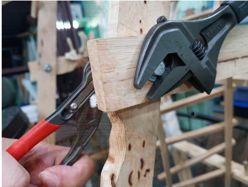
ภาพที่ 3-13 การขันน็อตด้วยประแจเลื่อนและคีม
