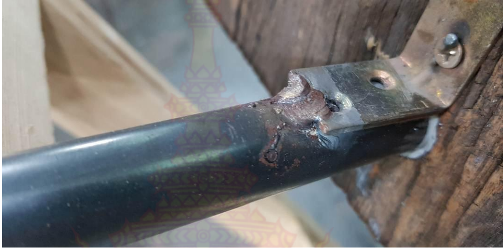
ภาพที่ 3-25 ลักษณะของรอยเชื่อมโลหะแบบ MMA
