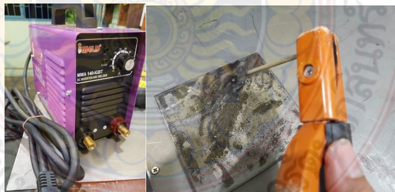
ภาพที่ 3-24 เครื่องเชื่อมโลหะไฟฟ้าแบบ MMA การเชื่อมโลหะด้วยไฟฟ้า
