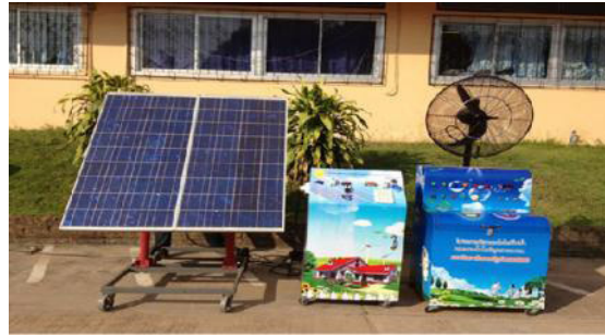
รูปที่ 6 ระบบผลิตน้ำแบบเคลื่อนที่ ที่มีการควบคุมอุณหภูมิ และความชื้นด้วยพลังงานแสงอาทิตย์
