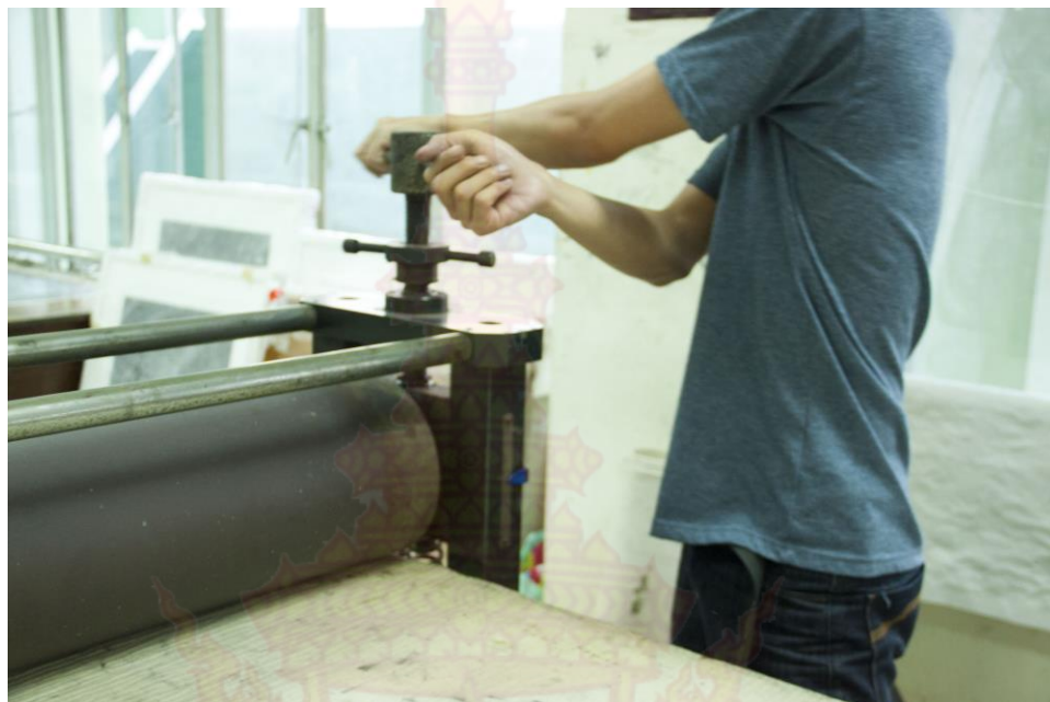
ภาพที่ 48 กำหนดน้ำหนักแรงกดของแท่นพิมพ์ ที่มา : ข้อมูลจากผู้เขียน
