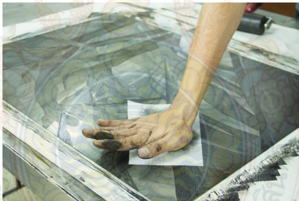
ภาพที่ 39 ใช้ผ้าและกระดาษซับหมึกเช็ดหมึก ที่มา : ข้อมูลจากผู้เขียน
