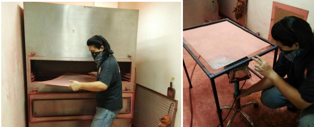
ภาพที่ 27 ภาพประกอบขั้นตอนที่ 7 นำแม่พิมพ์โลหะไปล้างวานิชออกด้วยน้ำมันสน ทินเนอร์ และน้ำยาล้างจาน เพื่อให้แผ่นแม่พิมพ์โลหะไม่มีความมัน ที่มา : ข้อมูลภาพจากผู้เขียน
