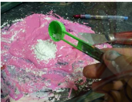
ผสมผงแม็กนีเซียมเข้าไปในสีที่ต้องการ กลิ้งสีบนแท่น ภาพที่ 28 ขั้นตอนการทำแม่พิมพ์ ที่มา: ข้อมูลจากผู้เขียน
