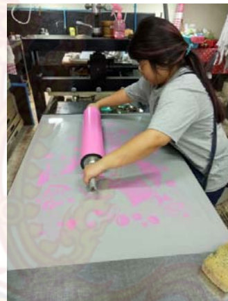
การวนสีหน้าแม่พิมพ์อลูมิเนียมออกให้สะอาด การกลิ้งสีลงบนแม่พิมพ์อลูมิเนียม ภาพที่ 31 ขั้นตอนการทำแม่พิมพ์ ที่มา: ข้อมูลจากผู้เขียน
