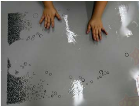
การรบกวนการกระถิ่นลงบนแม่พิมพ์อลูมิเนียม ใช้ผ้าสาหลวนลูบการกระถิ่นบนแผ่นแม่พิมพ์ให้บาง ภาพที่ 27 ขั้นตอนการทำแม่พิมพ์ ที่มา: ข้อมูลจากผู้เขียน
