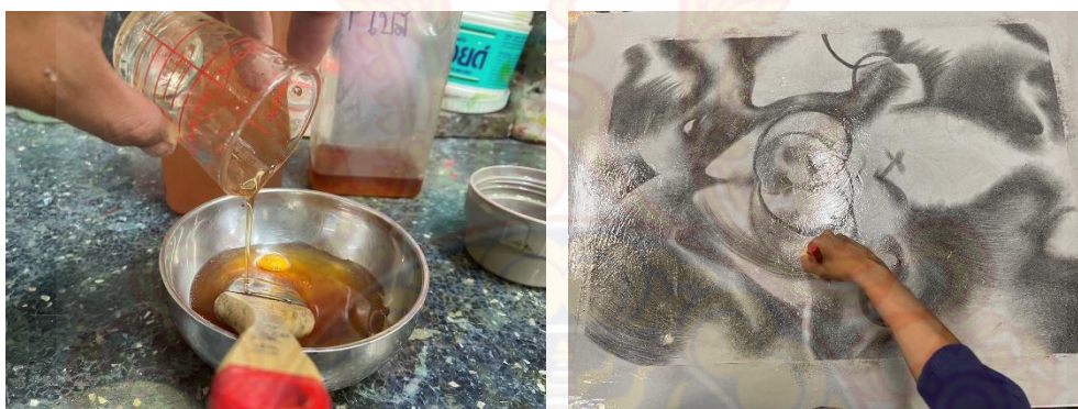
ภาพที่ 31 ขั้นตอนการกัดกรด โดยใช้แปรงลูบวนไปมา
