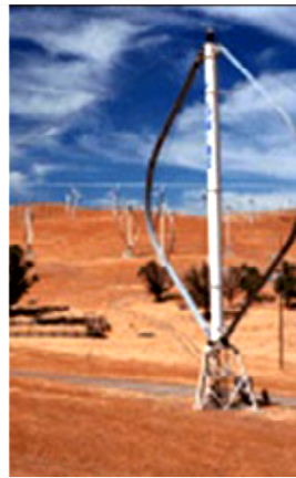
รูปที่ 1 ก กังหันลมผลิตไฟฟ้าชนิดแกนตั้ง และ ข กังหันลมผลิตไฟฟ้าชนิดแกนนอน [6]
