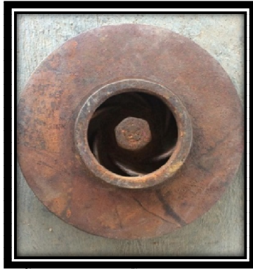
รูปที่ 2 ลักษณะกั้นน้ำที่ตัดแปลงจากปั๊มทอยโขงชนิดแรงเหวี่ยงหนีศูนย์กลาง
