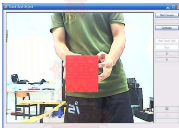
ภาพที่ 4-20 การนำเป้าสีแดงไว้ในระยะ 60 cm จากกล้องโดยปิดการใช้ค่าชดเชยแสงอัตโนมัติ
