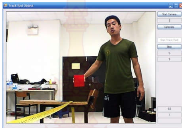
ภาพที่ 4-34 การนำเป้าสีแดงไว้ในระยะ 185 cm จากกล้องโดยเปิดการใช้ค่าชดเชยแสงอัตโนมัติ
