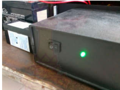
ภาพที่ 4-13 แสดงการติดของไป LED เมื่อเปิดสวิทช์
