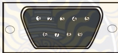
ภาพที่ 2-11 หัวเชื่อมต่อของ RS232 แบบ DB9
