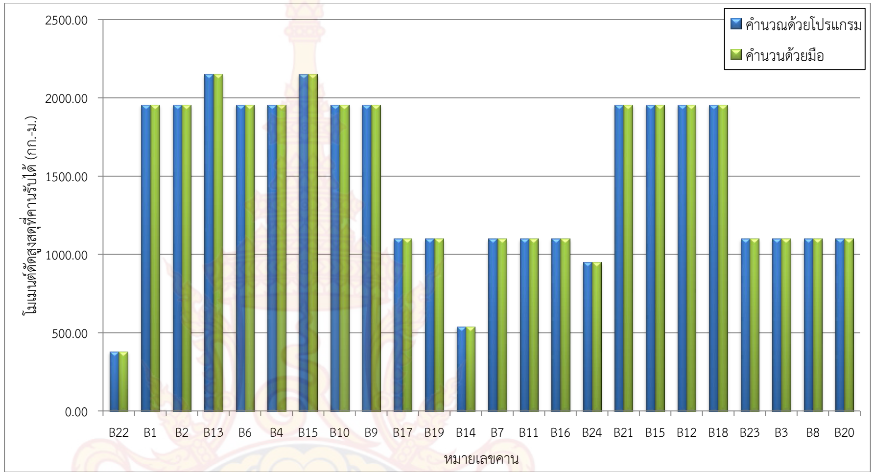
ภาพที่ 135 กราฟแท่งเปรียบเทียบผลการคำนวณโมเมนต์ดัดสูงสุดที่รับได้ของคานเหล็กแปดชนิดบ้านที่ 1
