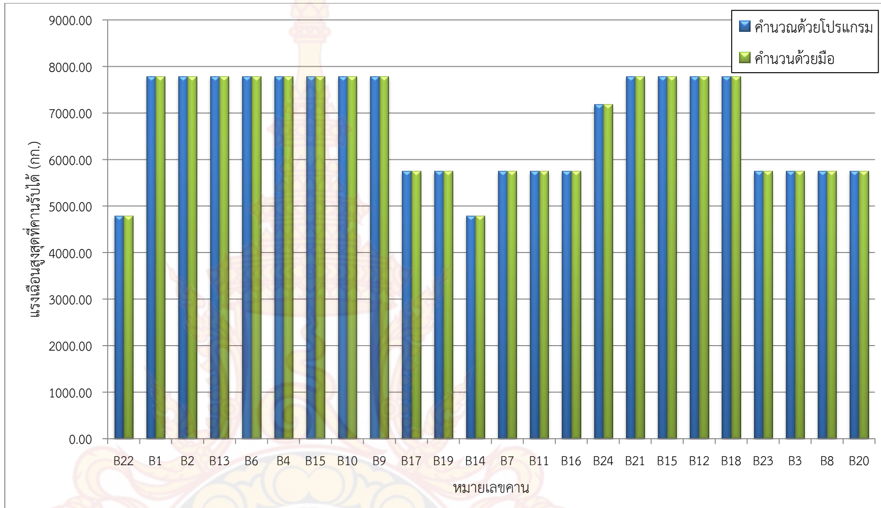
ภาพที่ 137 กราฟแท่งเปรียบเทียบผลการคำนวณแรงเค้นสูงสุดที่รับได้ของคานเหล็กเปลนบ้านที่ 1
