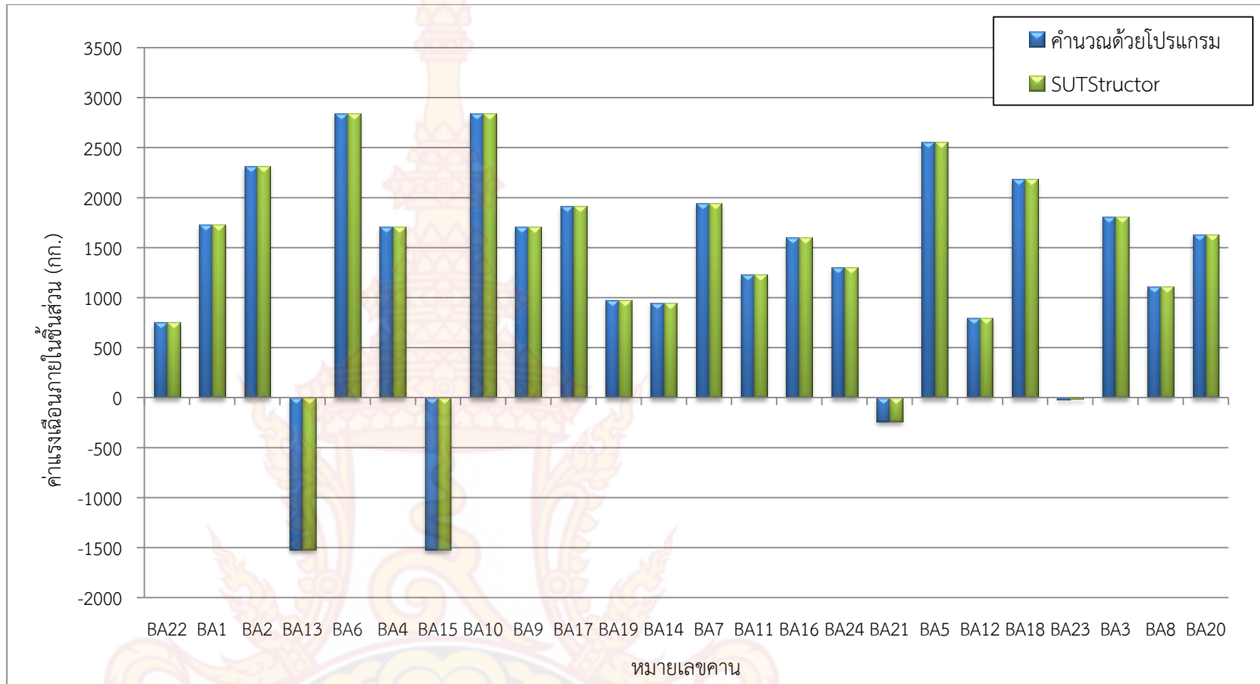
ภาพที่ 109 กราฟแห่งเปรียบเทียบผลการคำนวณของแรงเฉือนภายในชิ้นส่วนด้านซ้ายของคานแปลนบ้านที่ 1
