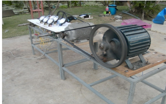
รูปที่ 3: เครื่องกำเนิดไฟฟ้าต้นแบบ 500 วัตต์
