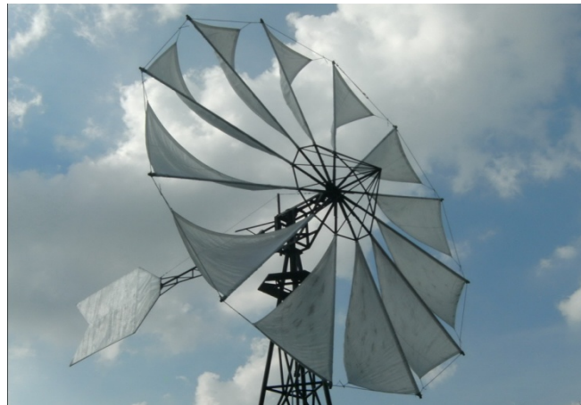
รูปที่ 2: กังหันลมแบบใบพัด จำนวน 12 ใบ
