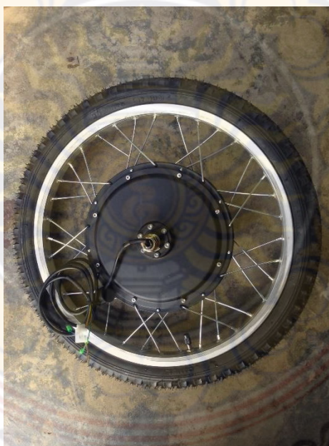
ภาพที่ 3-3 ประกอบ Brushless Dc Motor เข้ากับล้อขนาด 50.8 ซม.
