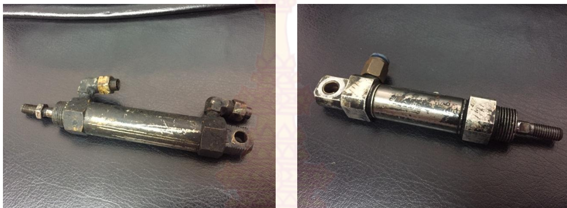
ภาพที่ 4.16 กระบอกลมลูกกวาวที่เสื่อมสภาพ
