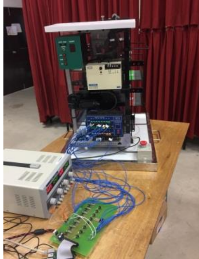
รูปที่ 8 อุปกรณ์วงจรอินพุตและเอาต์พุตที่สร้างขึ้น
