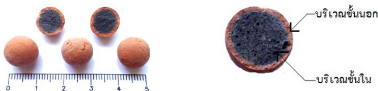
รูปที่ 1 ลักษณะผิวชั้นนอกและผิวชั้นในของเม็ดดินเหนียวเบา
