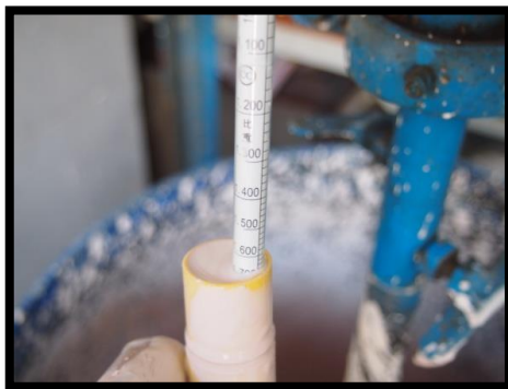
ภาพที่ 4 ใช้เครื่องมือวัดค่าความถ่วงจำเพาะ น้ำดินหล่อกว่งที่ 1.7
