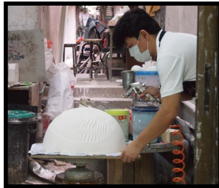
ภาพที่ 13 นำชิ้นงานเผาติดแล้วมาพ่นเคลือบใส
