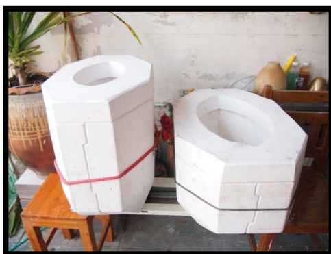
ภาพที่ 6 ประกอบพิมพ์เตรียมหล่อชิ้นงาน
