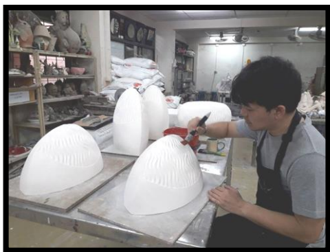
ภาพที่ 12 ตกแต่ง และนำชิ้นงานเข้าเผาติด อุณหภูมิ 800 องศาเซลเซียส
