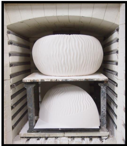
ภาพที่ 14 นำชิ้นงานที่เคลือบแล้วมาเข้าเผา อุณหภูมิ 1,220 องศาเซลเซียส
