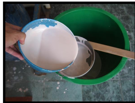
ภาพที่ 5 นำภาชนะมาตักน้ำดินออกจากถังกวน โดยใช้ตะแกรงกรองน้ำดินด้วย
