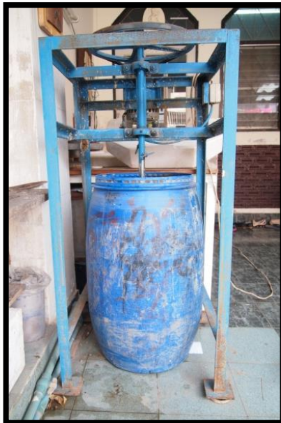
ภาพที่ 3 นำดินที่ย่อยมาใส่ในถังกวนดินพร้อม เติมน้ำเปิดเครื่องกวนจนดินเข้ากันกับน้ำ
