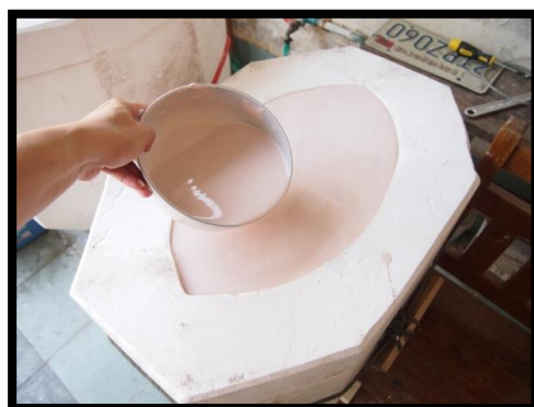
ภาพที่ 7 ใช้ภาชนะตักน้ำดินเทลงแบบพิมพ์ที่ เตรียมไว้และคอยสังเกตเมื่อน้ำดินยุบลงให้เติมน้ำดิน จนเนื้อดินมีความหนา 3 มิลลิเมตร จึงเอาน้ำดินออก
