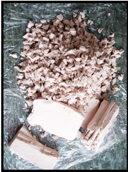
ภาพที่ 2 นำดินมาย่อยขนาดให้เล็กลง
