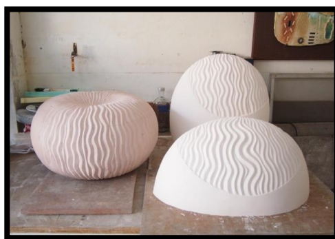
ภาพที่ 11 ชิ้นงานหลังนำออกจากแบบพิมพ์
