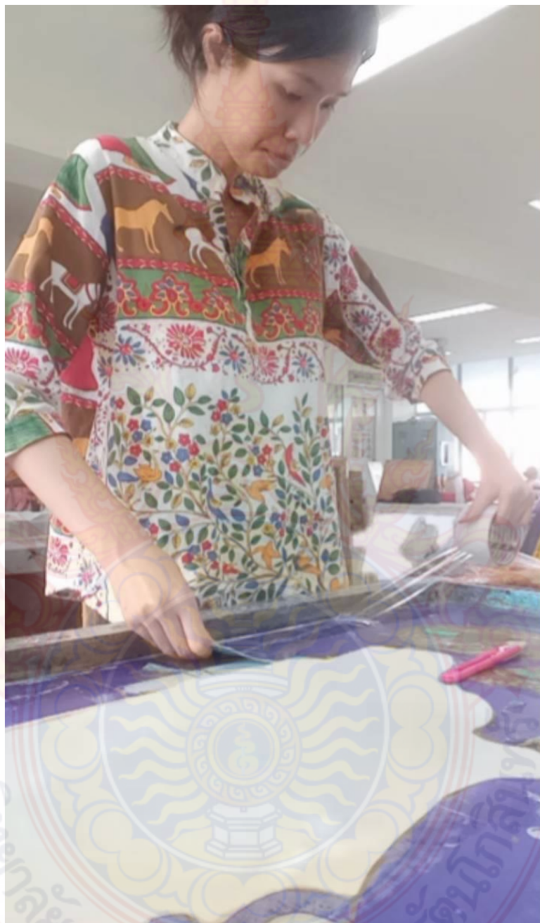
ภาพที่ 31 การติดเทปใสกันขอบบล็อกสกรีน ที่มา : ข้อมูลจากผู้เขียน
