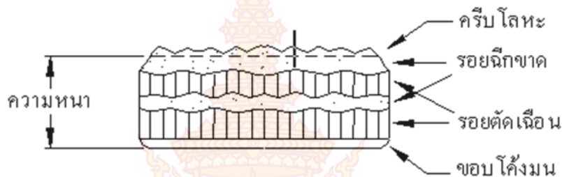
ภาพที่ 2.11 แสดงลักษณะชิ้นงานจากการใช้ระยะช่องว่างที่น้อยเกินไป
